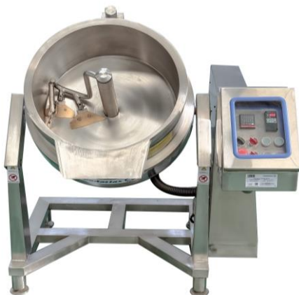
Рис.№1 Модель – XDC-50. Внешний вид модели и тип месильного органа
