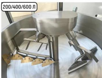
Рис 7. Типы месильных органов.
