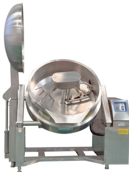
Рис №6 Модель – XDC -130DX. Внешний вид модели и тип месильного органа
