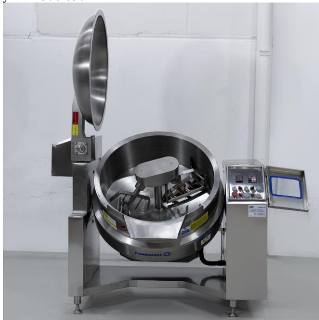
Рис №4 Модель – XDC-80X. Внешний вид модели и тип месильного органа
