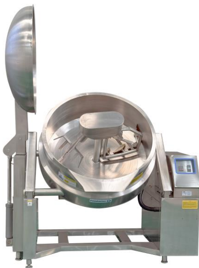
Рис №5 Модель – XDC -110DX. Внешний вид модели и тип месильного органа
